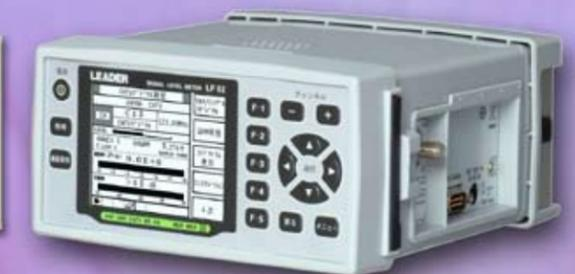
El nuevo LF 52 mide niveles de RF, C/N, VER, MER y perfiles de retraso. ¡Soporta ISDB-T, ISDB-Tb, VHF/UHF analógico y CATV!
