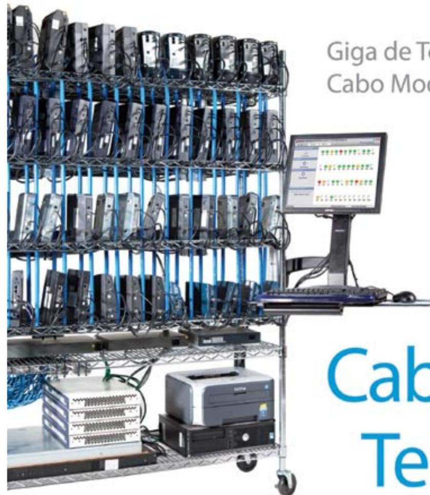
Giga de Testes Massivos para Cabo Modems e EMTAs
