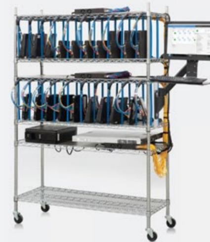
Promptlink ofrece una familia de probados bancos automáticos para pruebas funcionales completas y masivas -incluyendo la actualización automática de firmware, de todo tipo de terminales de video, voz y datos. Gracias a su procesamiento en paralelo, todos los bancos Promptlink realizan pruebas con muy alta velocidad y precisión. Sus poderosas bases de datos aseguran una completa trazabilidad de los resultados y permiten efectuar una variedad de análisis y estadísticas.
