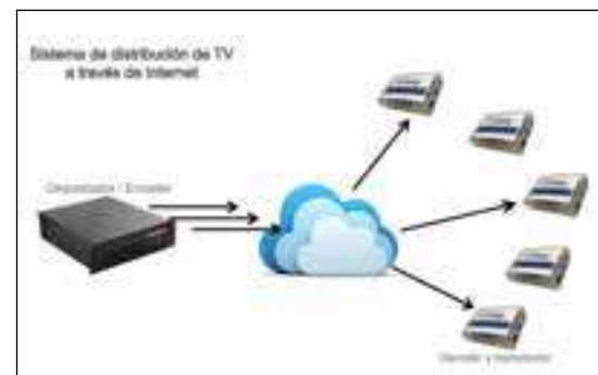
Sistema de distribución de TV de 3Way
