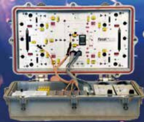
Nodo óptico modular para exteriores:
