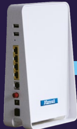
GPON ONT de doble frecuencia: WGP3200-DW
